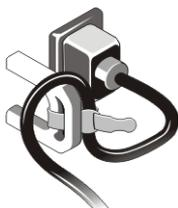
**Figure 6. Fixation du câble d'alimentation**
