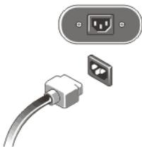
**Figure 5. Connexion d'alimentation**
